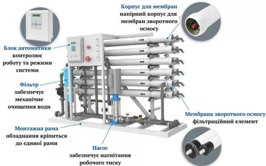
Рис. 2.6. Промислова система зворотного осмосу
